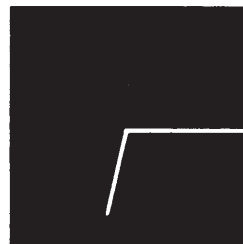
diodo en serie con 51 \Omega
